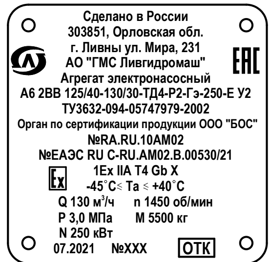
Рисунок 6 – Фирменная табличка (пример оформления)
